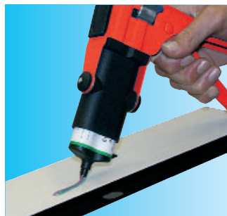
Dosierung bead on bead ohne Statikmischer
