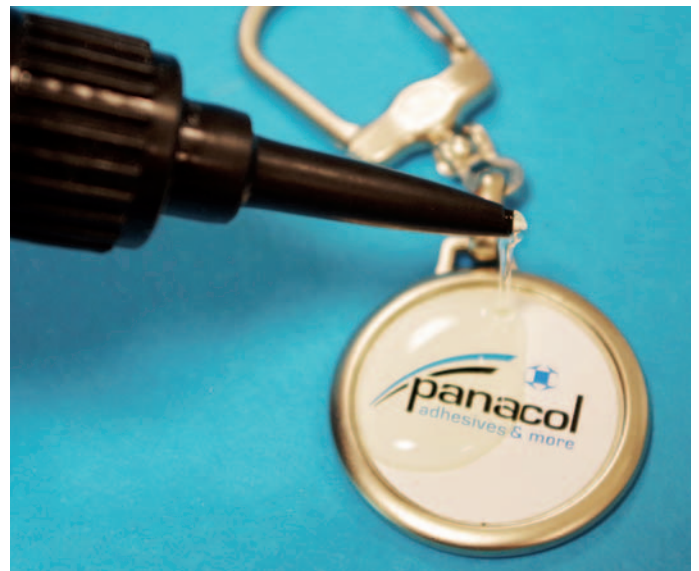
Ein transparenter Klebstoff auf Epoxidharzbasis wird als Dome Coating für Schlüsselanhänger verwendet
