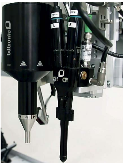
Plasmavorbehandlung und Klebstoffauftrag können in einer Fertigungszelle umgesetzt werden.
