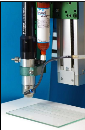
Sprühdosiereinheit eco-SPRAY zur Auftragung von Panacol Klebstoffen.
